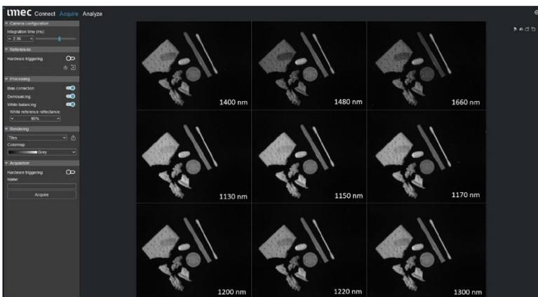
imec의 초분광 이미징 획득 소프트웨어: 여러 물체(건조 및 촉촉한 케이크, 플라스틱 PET 및 PVC, 너트 및 껍질)가 SNm3X3 = 9 스펙트럼 색상 타일 뷰에 표시됩니다. HIS 데이터 큐브는 200 FPS 이상으로 분류할 수 있습니다.(다음 페이지 참고)
